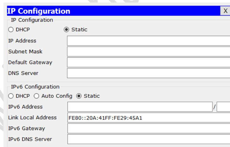
Pada kotak dialog *IP Configuration*, secara default telah terpilih **Static** untuk pengaturan pengalaman IP secara statik. Lengkapi isian parameter *IP address* dan *Subnet Mask* menggunakan alamat **IP ketiga** dari alamat *subnet* untuk **LAN HQ Mataram** berdasarkan hasil perhitungan *VLSM* pada tugas 1 yaitu **192.168.255.3/26** serta *default gateway* **192.168.255.1**, seperti terlihat pada gambar berikut:
