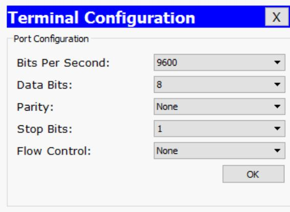
Nilai parameter pada *Port Configuration* telah sesuai dengan ketentuan koneksi dari PC ke *port Console* dari *Router* maka klik tombol *OK*.
