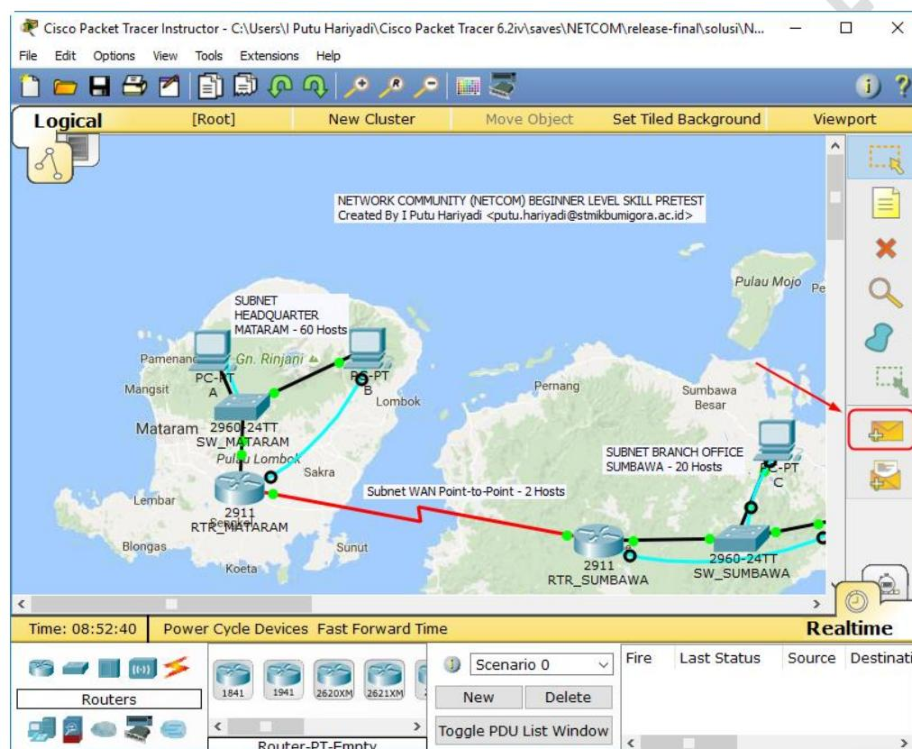
*Pointer* akan berubah menjadi simbol amplop. Pertama, klik pada *PC A* sebagai sumber dan kemudian *PC B* sebagai tujuan. Hasil dari proses verifikasi koneksi menggunakan *Simple PDU* terlihat pada bagian *User Created Packet Window* yang terdapat di pojok kanan bawah dari antarmuka *Cisco Packet Tracer*, seperti terlihat pada gambar berikut:
