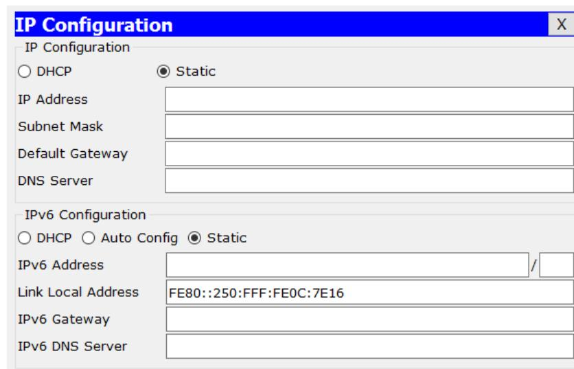
Pada kotak dialog *IP Configuration*, secara default telah terpilih **Static** untuk pengaturan pengalamatan IP secara statik. Lengkapi isian parameter *IP address* dan *Subnet Mask* menggunakan alamat **IP ketiga** dari alamat *subnet* untuk **LAN Branch Office Sumbawa** berdasarkan hasil perhitungan *VLSM* pada tugas 1 yaitu **192.168.255.67/27** serta *default gateway* **192.168.255.65**, seperti terlihat pada gambar berikut:
