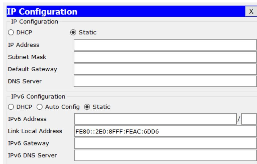
Pada kotak dialog *IP Configuration*, secara default telah terpilih **Static** untuk pengaturan pengalaman IP secara statik. Lengkapi isian parameter *IP address* dan *Subnet Mask* menggunakan alamat **IP keempat** dari alamat *subnet* untuk **LAN HQ Mataram** berdasarkan hasil perhitungan *VLSM* pada tugas 1 yaitu **192.168.255.4/26** serta *default gateway* **192.168.255.1**, seperti terlihat pada gambar berikut:
