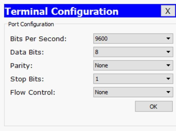
Nilai parameter pada *Port Configuration* telah sesuai dengan ketentuan koneksi dari PC ke *port Console* dari *Switch* maka klik tombol *OK*.
